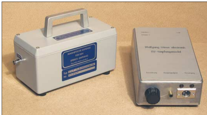
Bild 5: Dieser zweiteilige Empfänger stellt eine kompakte Anordnung auf Basis des UAP-Systems dar.
