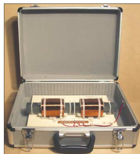
Bild 3: Die in einem Aluminiumkoffer untergebrachte Zweifach-Induktionsspule besitzt einen 36 cm langen Ferritkern mit sehr hoher Permeabilität.
