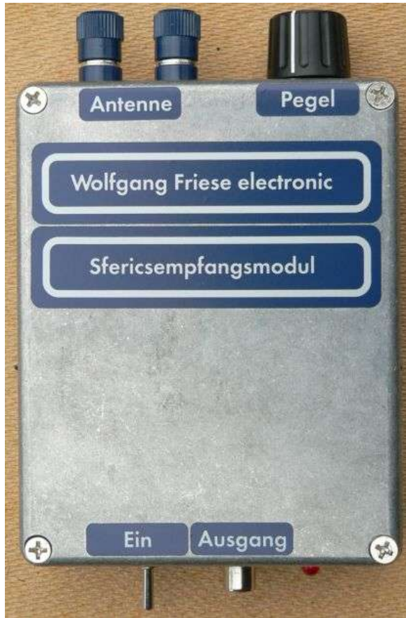
Oben: Das Sfericsempfangsmodul SEM EBSA, rechts: Blick in das geöffnete Gehäuse
